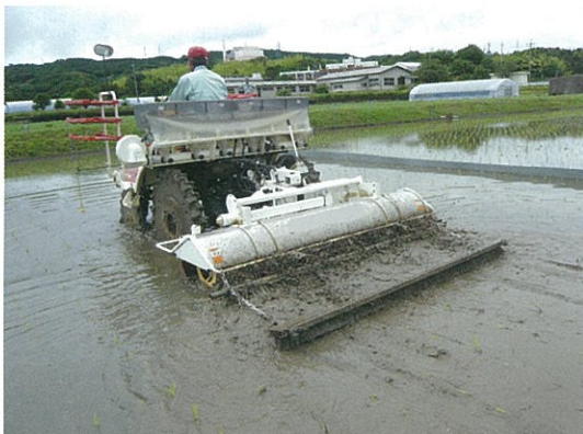
写真-2 チェーン・ブラシ除草器具を取り付けた高精度水田用除草機による機械除草
