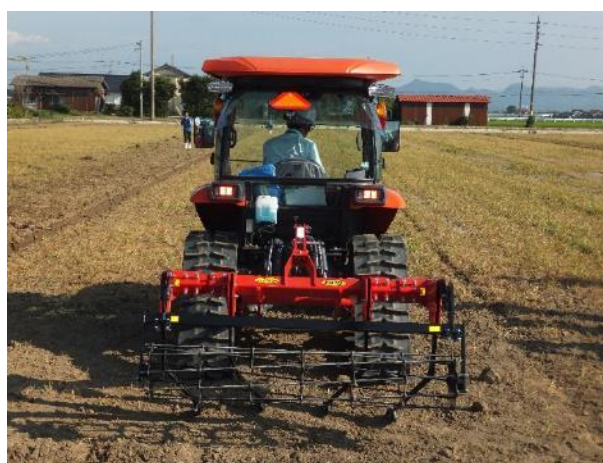
排水対策実演（パラソイラー）
