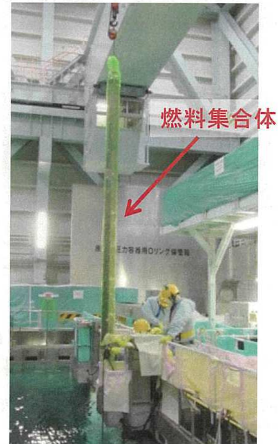
新燃料の引き上げ状況
