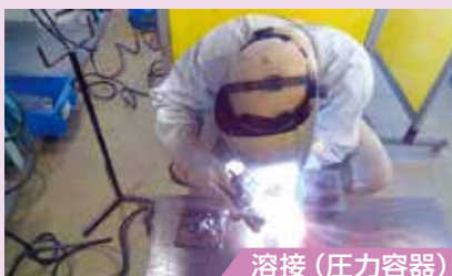
溶接(压力容器)
