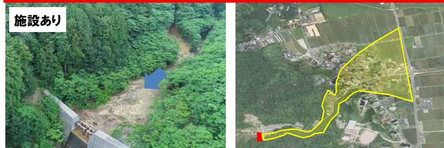
砂防堰堤による土砂捕捉
