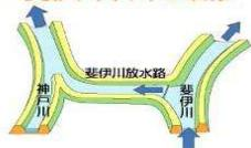
中海・宍道湖への洪水の流入量を減らすため、放水路を建設し斐伊川から神戸川へ洪水の一部を分流します。
