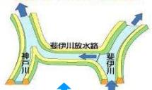
中海・宍道湖への洪水の流入量を減らすため、放水路を建設し斐伊川から神戸川へ洪水の一部を分流します。
