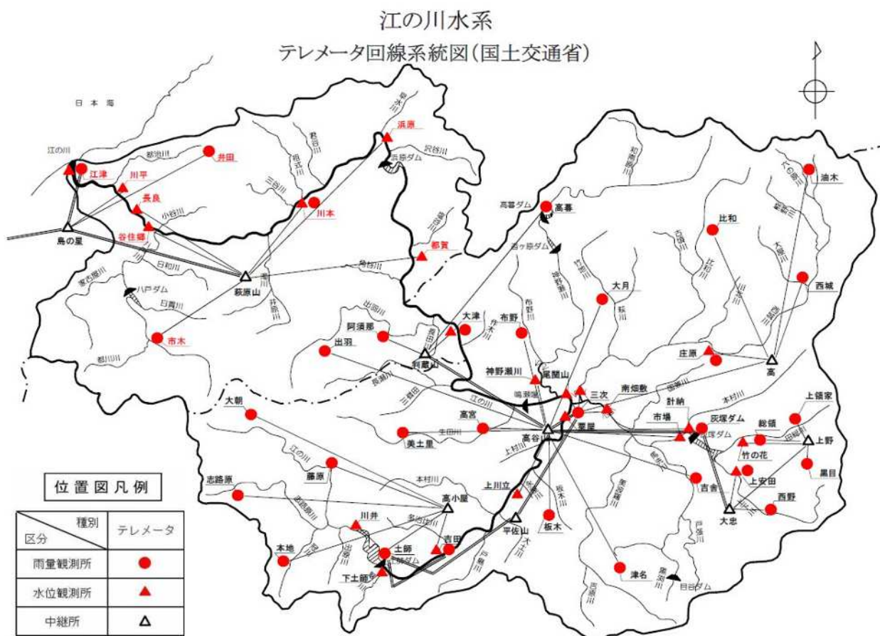
B-2 図(11) 江の川水系テレメーター回線系統図 (国土交通省)
