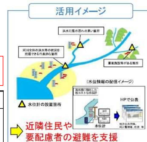
洪水に特化した低コストな水位計の設置例
