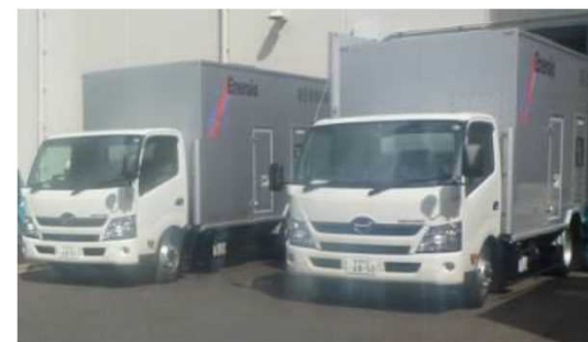
高圧発電機車
