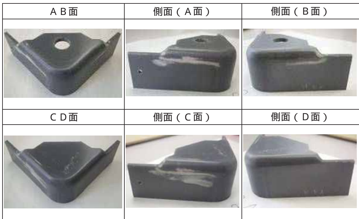
別紙 6 - 図 6 腐食試験結果 (シールドガス流量影響評価試験片 ( 規定値の 2 5 倍 ) ) ( バッチ式 , 5 0 0 水蒸気 , 2 4 時間 )
