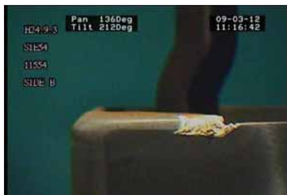
No. 8 11554 (神戸製鋼) 欠損部長さ 約17mm (B面)
