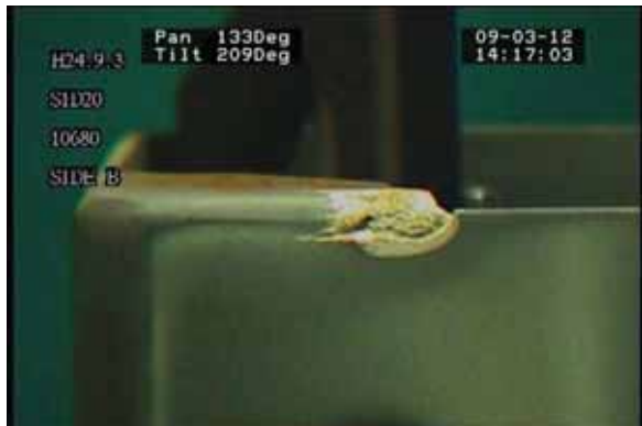
No. 3 10680 (神戸製鋼) 欠損部長さ 約18mm (B面)
