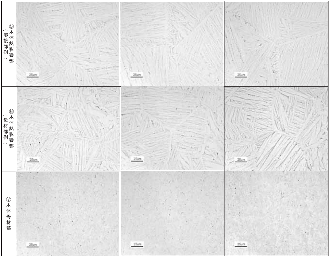
別紙2-図3-8 断面ミクロ析出物観察結果 (2/2) (手動溶接 D面 観察倍率400倍)
