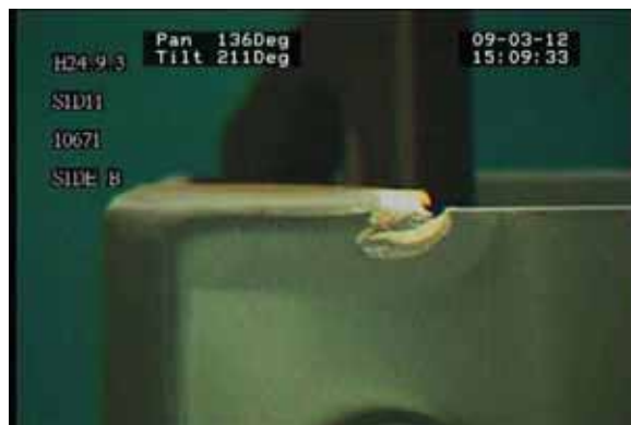
No. 2 10671 (神戸製鋼) 欠損部長さ 約12mm (B面)
