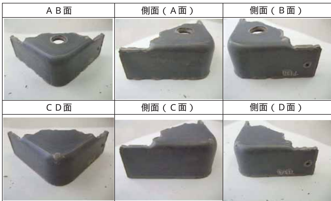
別紙 6 - 図 1 6 腐食試験結果 ( 入熱影響評価試験片 ) ( バッチ式 , 5 2 5 水蒸気 , 7 2 時間 )
