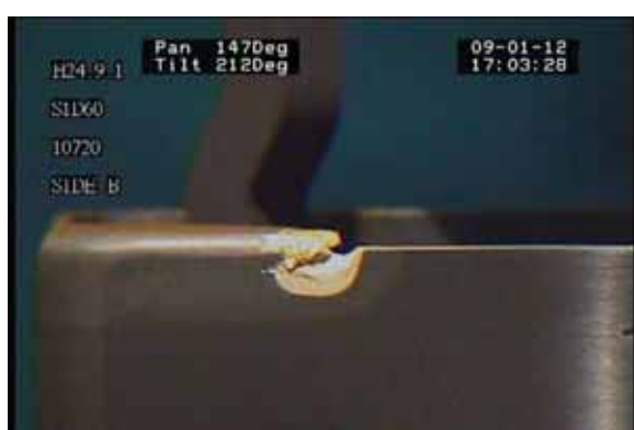
No. 6 10720 (神戸製鋼) 欠損部長さ 約13mm (B面)
