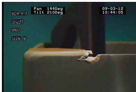
No. 10 9507 (神戸製鋼) 欠損部長さ 約13mm (B面)
