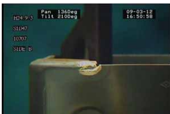
No. 5 10707 (神戸製鋼) 欠損部長さ 約14mm (B面)
