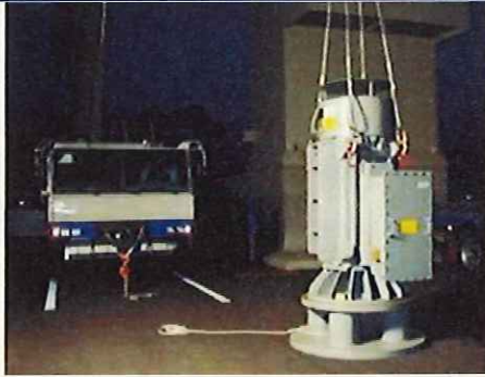
▲敷地内に配備した原子炉補機海水ポンプ電動機の予備品
