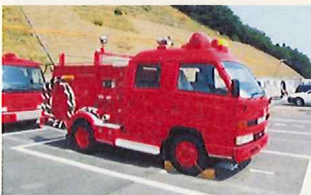
▲代替注水を行うための消防ポンプ車を配備。今後さらに追加配備する
