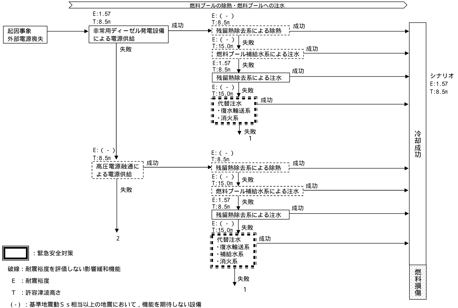
地震・津波の起因事象に対するイベントツリー（燃料プール）(1/2)
