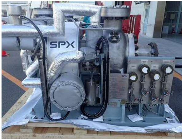
高圧原子炉代替注水ポンプ
