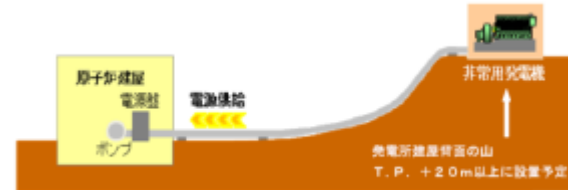
非常用発電機の高台設置の例 (中部電力HPより)
