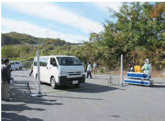
ゲート型モニタを使用した車両の検査 (令和元年度原子力防災訓練)
