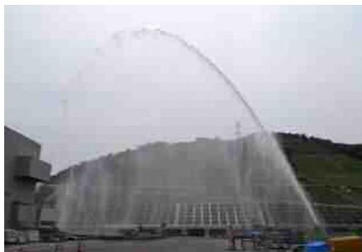
大気への放射性物質の拡散抑制(実放水試験時)
