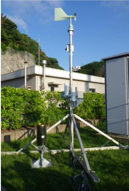
(風向風速計, 日射計, 放射収支計, 雨量計, 温度計, 湿度計)
