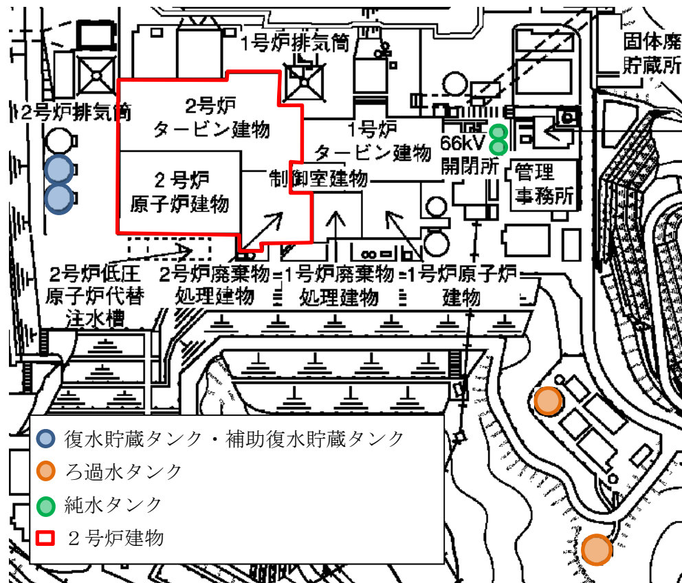
図7 建物内への流入を抑制する大型タンク
