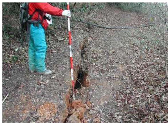
写真 2.9 クラック（地割れ）の例
