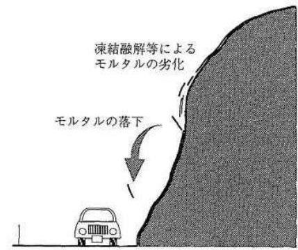
図 2.1 吹付自体の劣化による崩落
