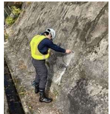
写真 1.7 ファイバースコープによる調査
