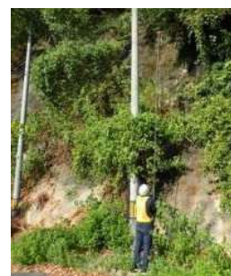
写真 1.3 ポールカメラによる調査
