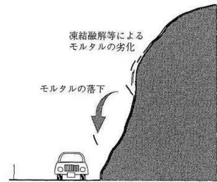
図 2.1 吹付自体の劣化による崩落
