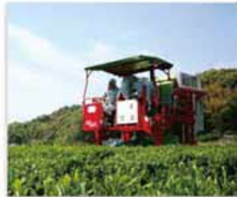
機械による茶収穫作業の省力化(例.乗用摘採機：右写真)
