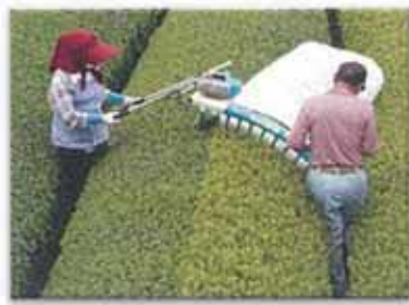
機械による茶収穫作業の省力化(例.乗用摘採機：右写真)
