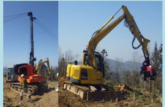
写真1 高性能林業機械 (左:タワーヤーダ 右:ハーベスタ)
