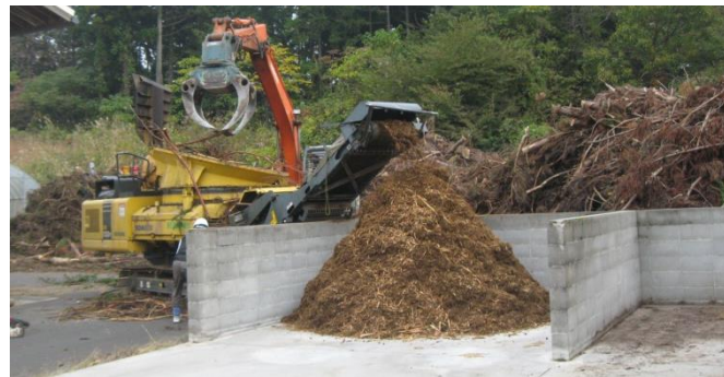
写真2 枝などを破砕してチップにする作業
