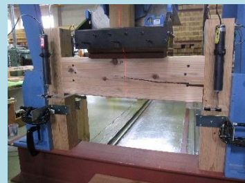
金物接合部の性能試験（柱－梁）
