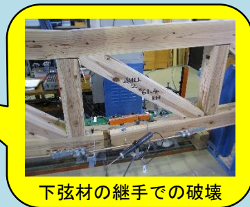
平行弦トラスの開発 ー長さ8mでの曲げ強度試験ー ・破壊荷重はおよそ6トン
