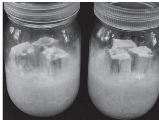
写真 2 腐朽処理 (ヒノキ辺材, カワラタケ)
