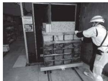
写真1 乾燥機から搬出される試験体
