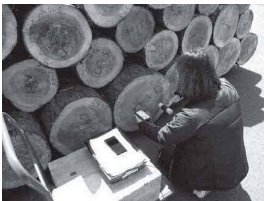
写真1 簡易型強度測定器によるはい積みしたスギ原木のヤング係数測定
