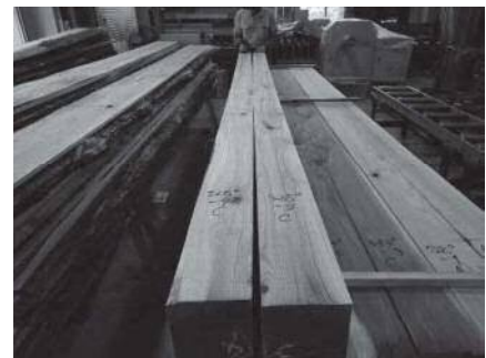
写真1 曲りが生じた試験体
