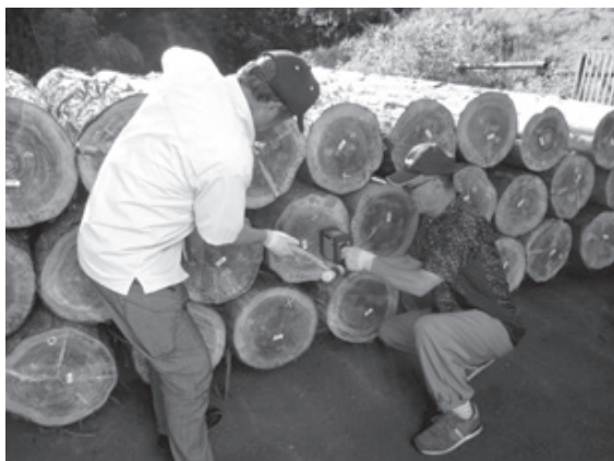
写真-1 はい積み状態でのスギ原木の強度（動的ヤング係数）測定
