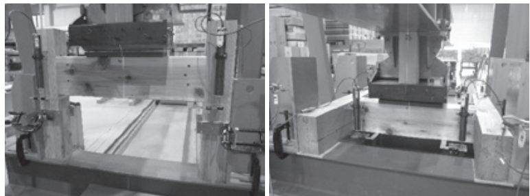
写真－2 金物工法で接合した仕口接合部のせん断試験 （左：柱－梁型、右：梁－梁型）
