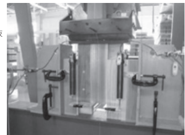
写真-1 相欠き接合でのせん断試験
