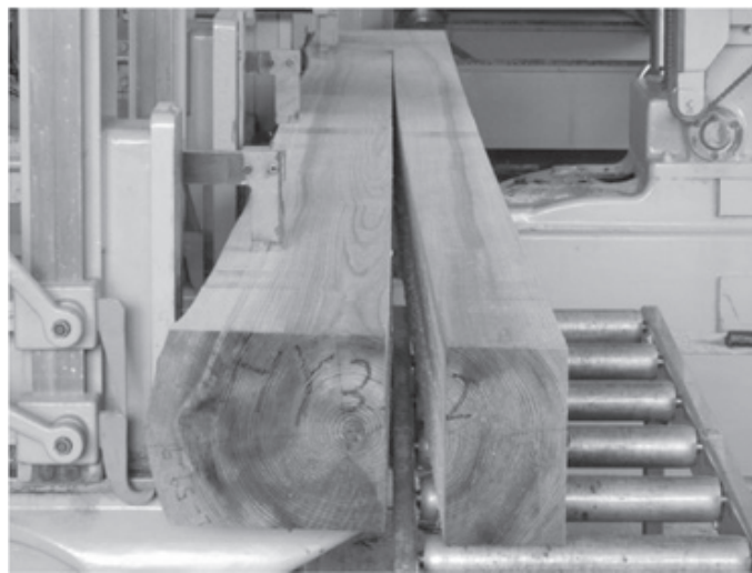
写真-1 心去り材に生じた製材時の狂い（縦ぞり）
