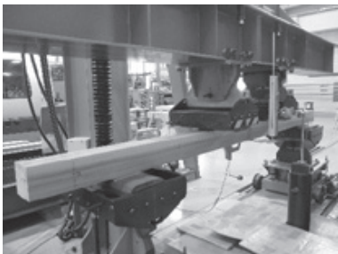
写真－1 心去り正角の曲げ試験
