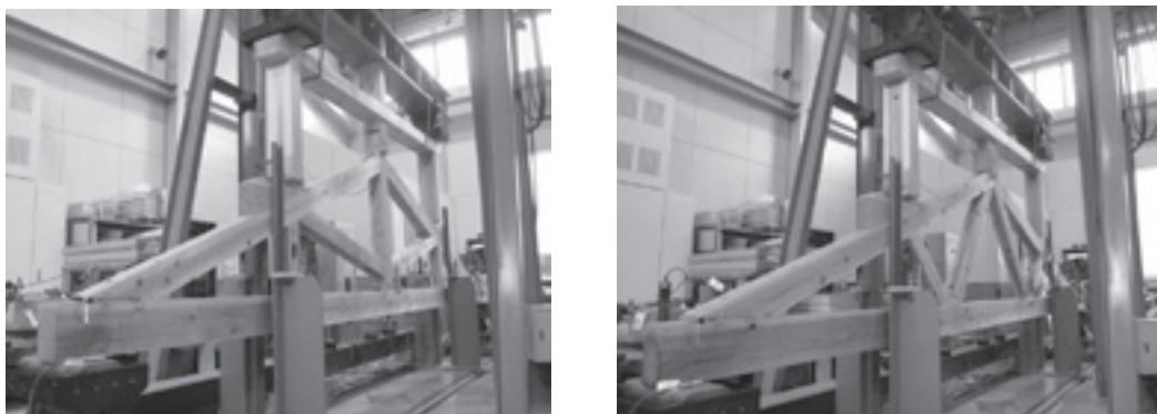
写真-1 スギ製材を用いてプレカットにより製造したハウトラス（左）とフィンクトラス（右）
