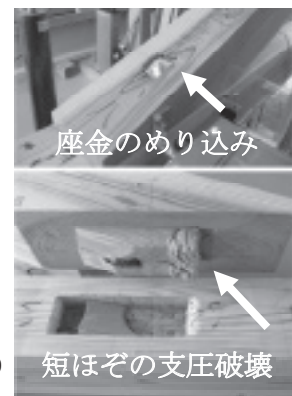
写真-2 合掌尻での破壊
