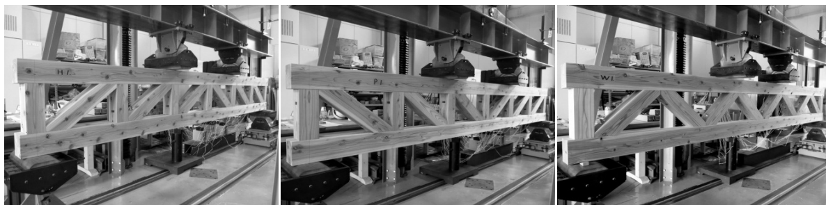
写真-1 試験した 3 種類の平行弦トラス (左：ハウトラス，中央：プラットトラス，右：ワーレントラス)
