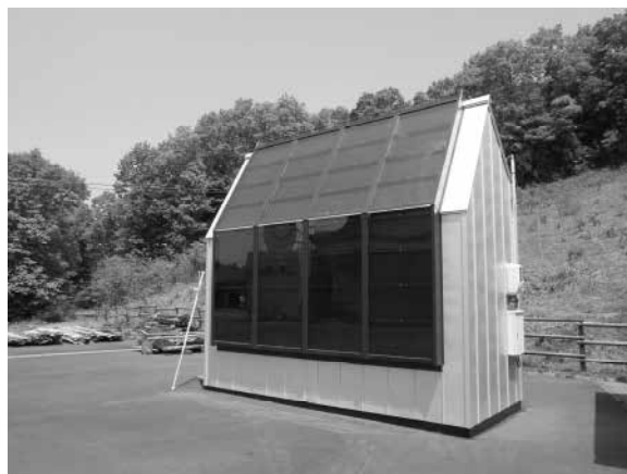
写真－1 太陽熱を利用した木材乾燥装置
