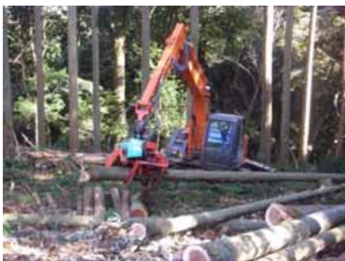
写真-2 プロセッサによる造材作業
