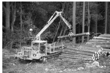
写真－2 フォワーダへの積み込み
