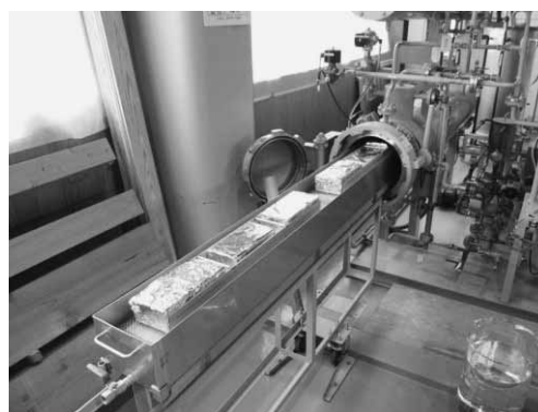
写真-2 減圧加圧注入装置
