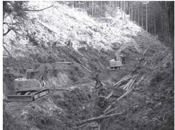
写真-1 集材～造材の連携作業
