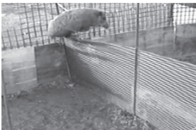
写真-1 2段重ねのトタンを跳び越す
