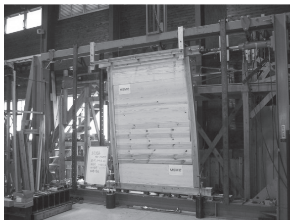
写真-1 試験壁体の面内せん断試験 (広島県立総合技術研究所 林業技術センターにて実施。)
