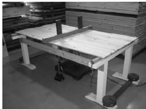
写真－1 幅はぎ板のMOE測定
