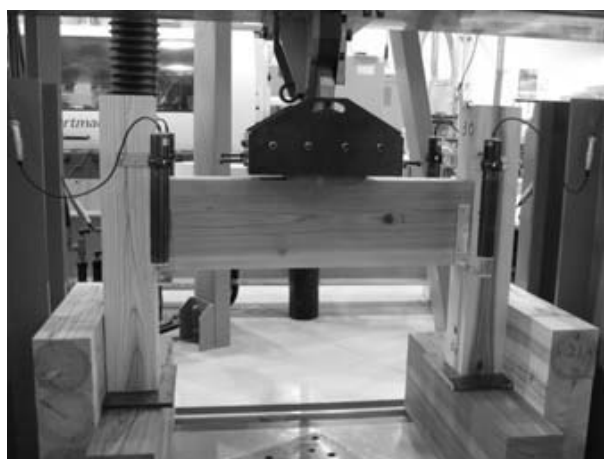
写真－1 接合部破壊試験
