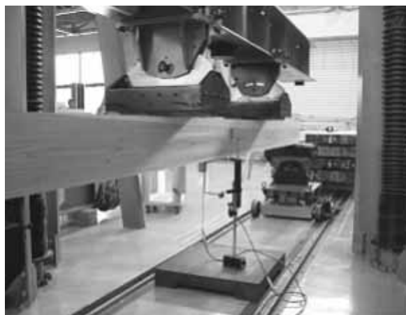
写真1 実大曲げ破壊試験
