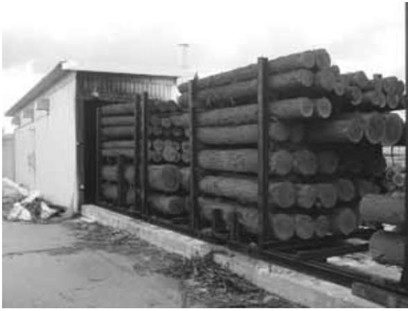
写真1 燻煙熱処理後のコナラ丸太
