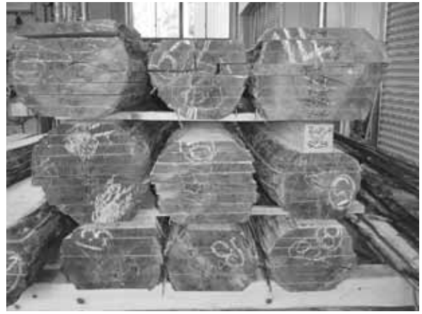
写真2 燻煙熱処理丸太から製材したコナラ板
