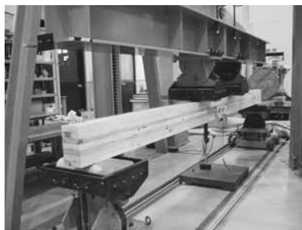
写真2 集成材の曲げ試験
