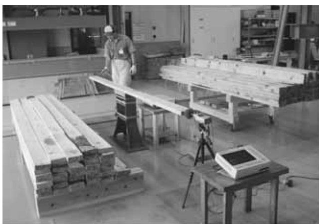
写真1 打撃音法によるラミナの強度等級区分
