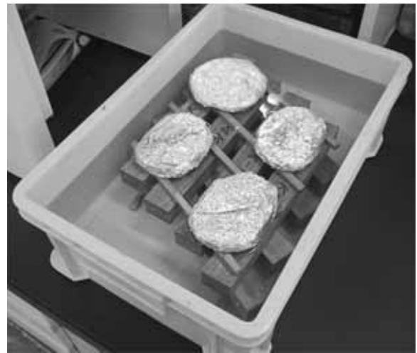
写真1 LVLの浸せきはく離試験
