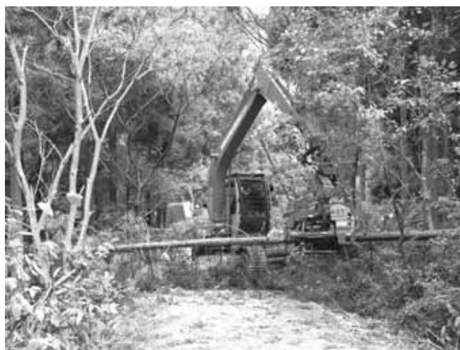
写真1 プロセッサを利用した造材作業
