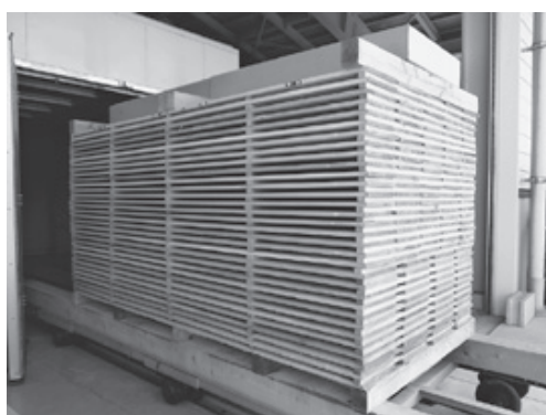
写真V-2 栈積みの状況（最上段は圧縮材）
