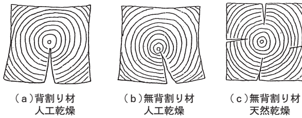
図II-16 柱材断面の乾燥に伴う形状変化 (久田)
