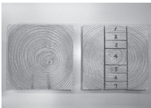
写真Ⅱ－９ 含水率傾斜測定試験片
