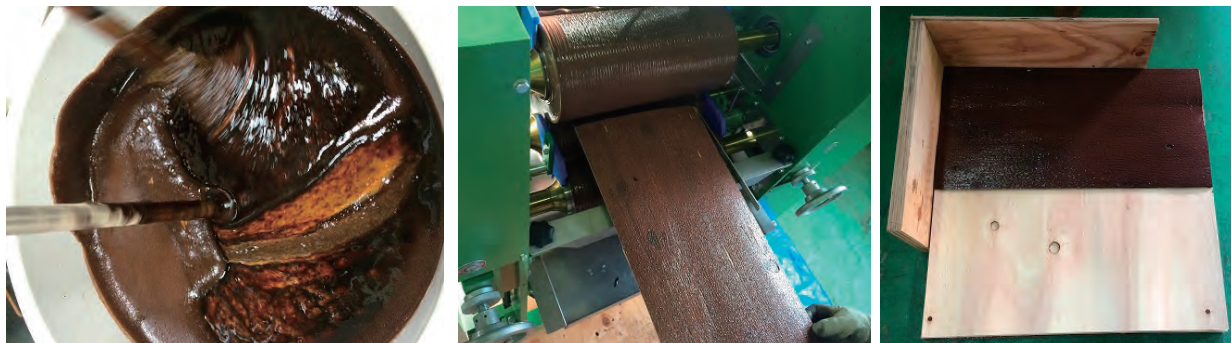
合板試作の直前に調製物ⅠとⅡの混合。小型塗布装置で単板接着剤塗布、12×600×600mm合板試作
