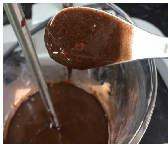
D 硬化剤が 1.2mol 水酸化ナトリウムに溶けてから、6 部の小麦粉だけで粘度が高くなっている。
