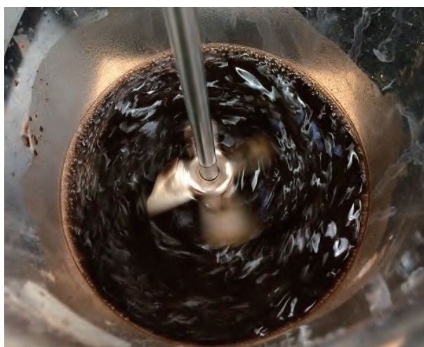
D 硬化剤が 1.2mol 水酸化ナトリウムに溶けてから、6 部の小麦粉だけで粘度が高くなっている。
