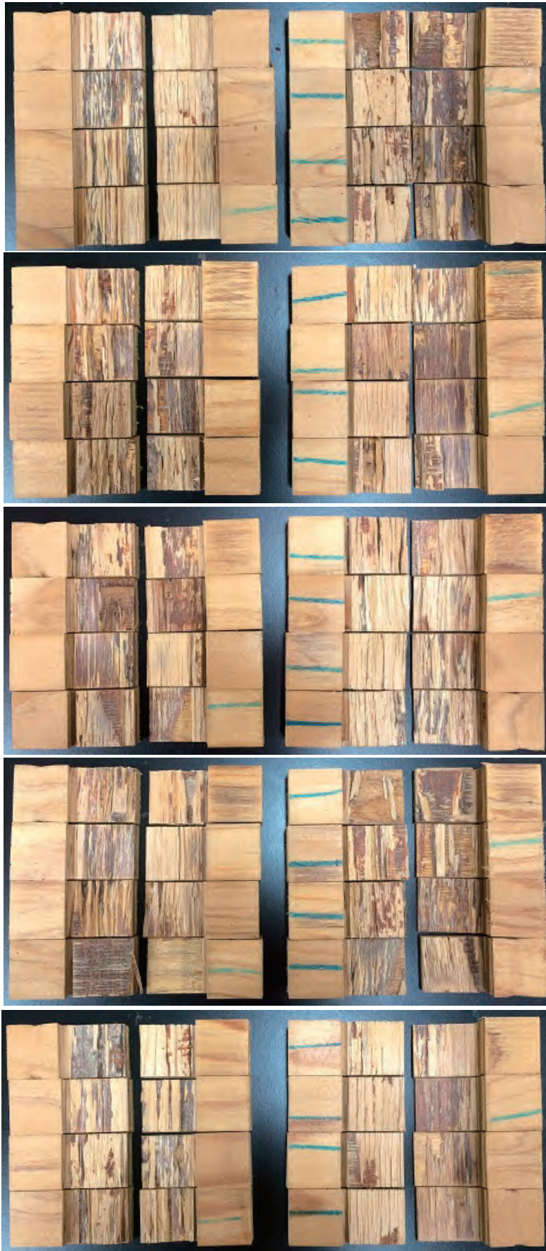
引張りせん断強さ試験後の各試験片（木破の状態）写真
