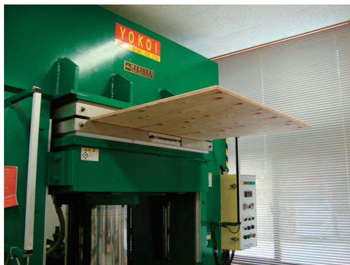
構造用合板試作品の熱圧温度 160℃による再圧縮
