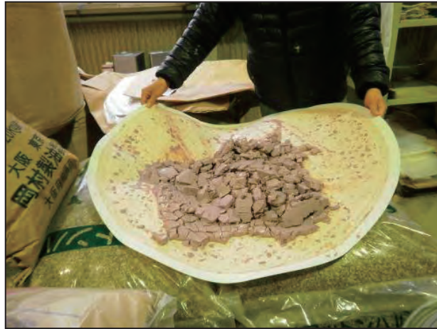
▲プラント製造リグノフェノール
