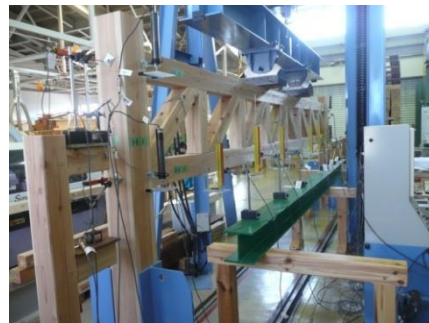
曲げ試験(たわみ, ひずみの計測)
