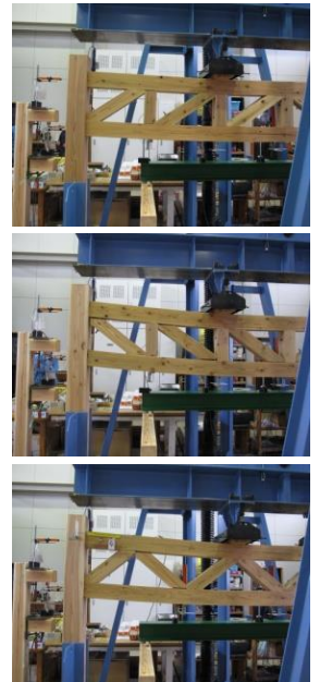
各柱-トラス梁の最大荷重時の変形の比較
