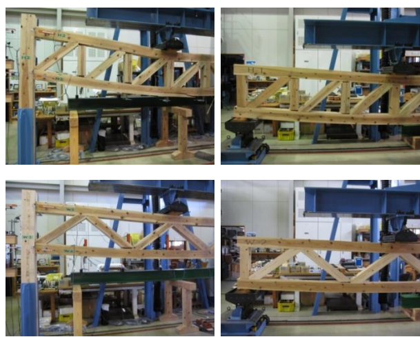
柱-トラス梁とトラス梁の最大荷重時の変形の比較
