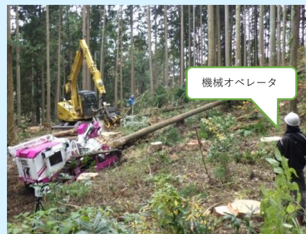
遠隔操作による伐倒～集材作業の機械化
