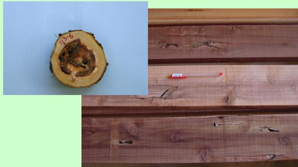
写真2 スギカミキリによる被害
