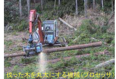
伐った木を丸太にする機械(プロセッサ)
