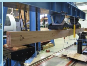
スギ心去り梁材の 曲げ破壊試験
