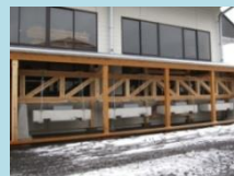
トラス梁の長期载荷試験
