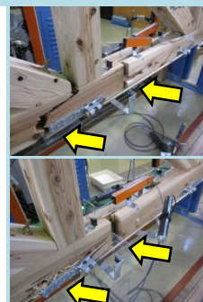
トラス梁の曲げ性能 (長さ 8 m, 間隔 0.91 m) と特徴的な破壊の様子 (引張り側の継ぎ手)
