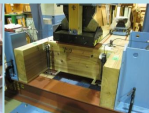
金物接合部の破壊 試験 (梁-梁接合部)
