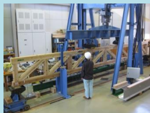
トラス梁の曲げ 破壊試験 (長さ 8 m)
