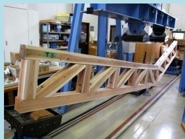
実大曲げ破壊試験と破壊の様子（最大荷重7.7トン）
