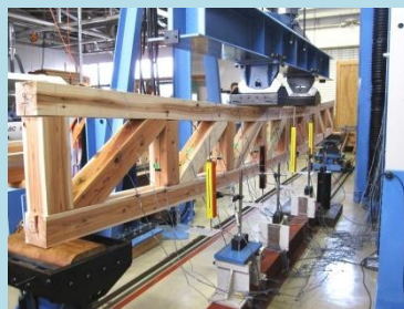
実大曲げ破壊試験と破壊の様子（最大荷重7.7トン）
