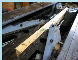
接合部要素試験 (左：継手の引張り、右：仕口のせん断)
