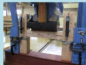
接合部要素試験 (左：継手の引張り、右：仕口のせん断)
