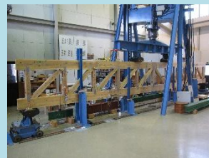
実大性能確認のための曲げ試験
