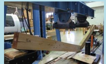
実大曲げ強度試験
