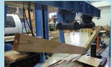
実大曲げ強度試験
